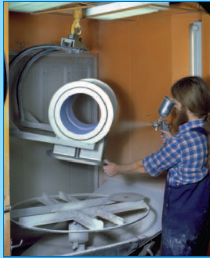
Нанесение покрытие эмали
