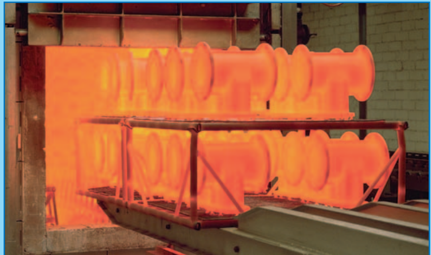
Завершение процесса отжига универсальных задвижек
