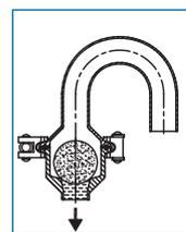
При давлении ниже атмосферного, шар падает на нижнее седло клапана. \* воздушное отверстие необходимо для облегчения процесса опустошения ёмкости.
