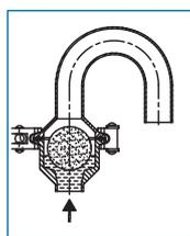
Уровень продукта поднимается, шар держится на поверхности, позволяя отводить воздух до тех пор, пока шар не вынужден перекрыть отверстие и предотвратить утечку продукта.
