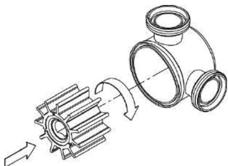
Перед установкой крыльчатки (02) ее следует смазать консистентной смазкой. Для применения в пищевой промышленности используйте безопасную для здоровья смазку.
