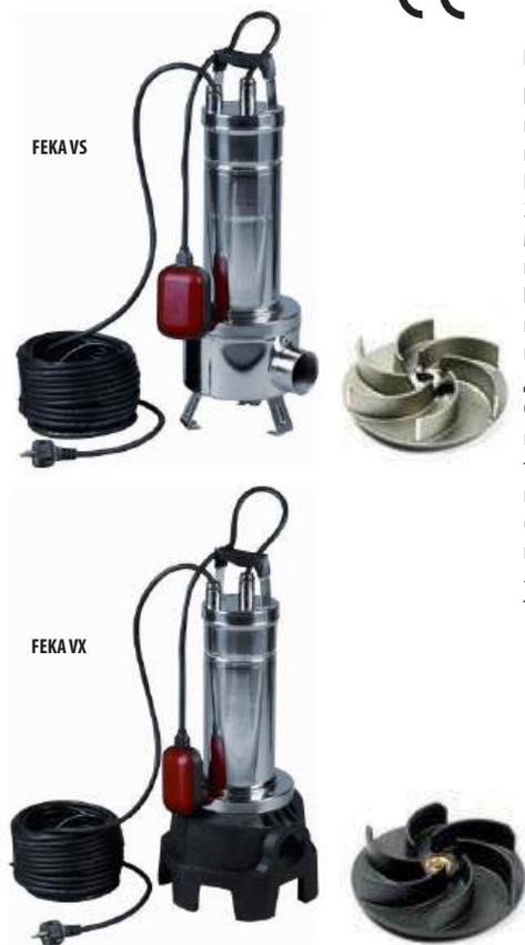
**Назначение.** Разработано специально для индивидуальных и коллективных систем дренажа и водоотведения, в том числе и фекальных вод. Рабочий диапазон. Производительность: от 0,8 до 32 куб.м/ч, напор: до 14 м. водяного столба.
