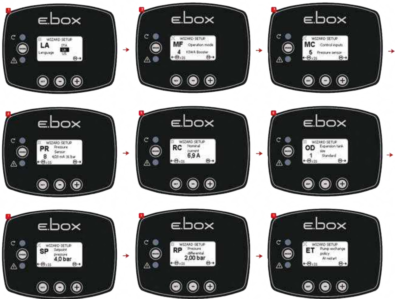
Схема 48: Підвищення тиску KIWA з датчиком тиску
