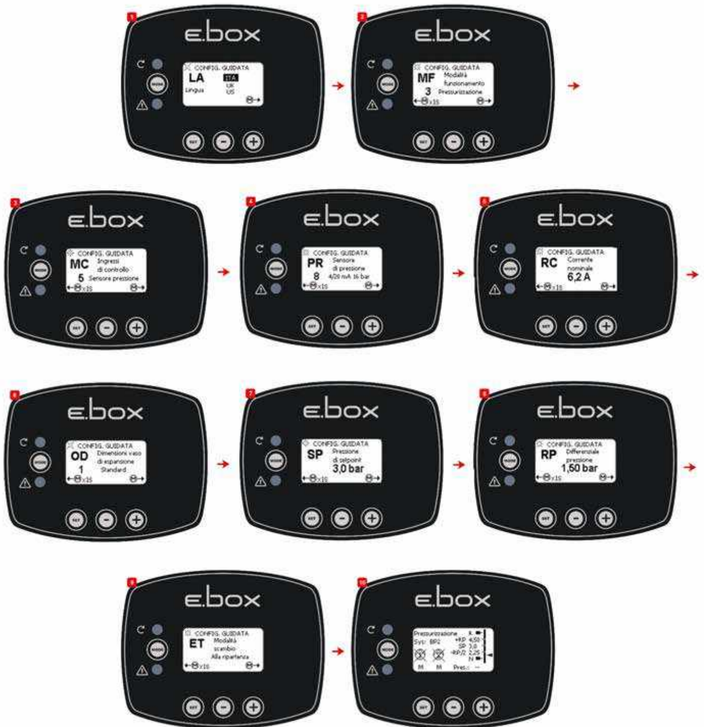
Схема 12: Конфигурация с датчиком давления
