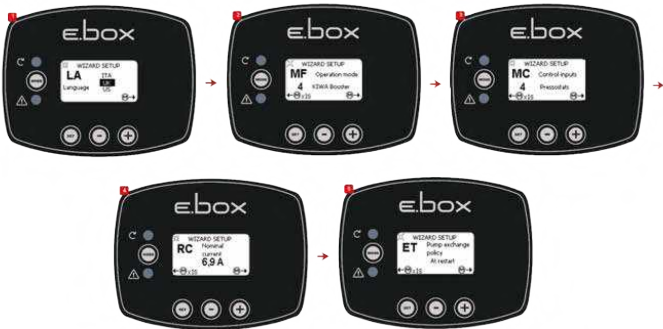
Схема 49: Конфігурація KIWA з реле тиску
