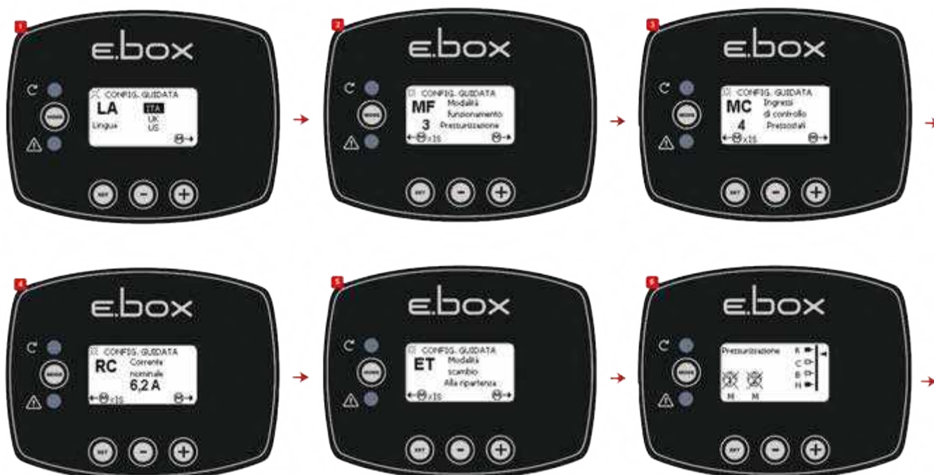
Схема 13: Конфигурация с реле давления
