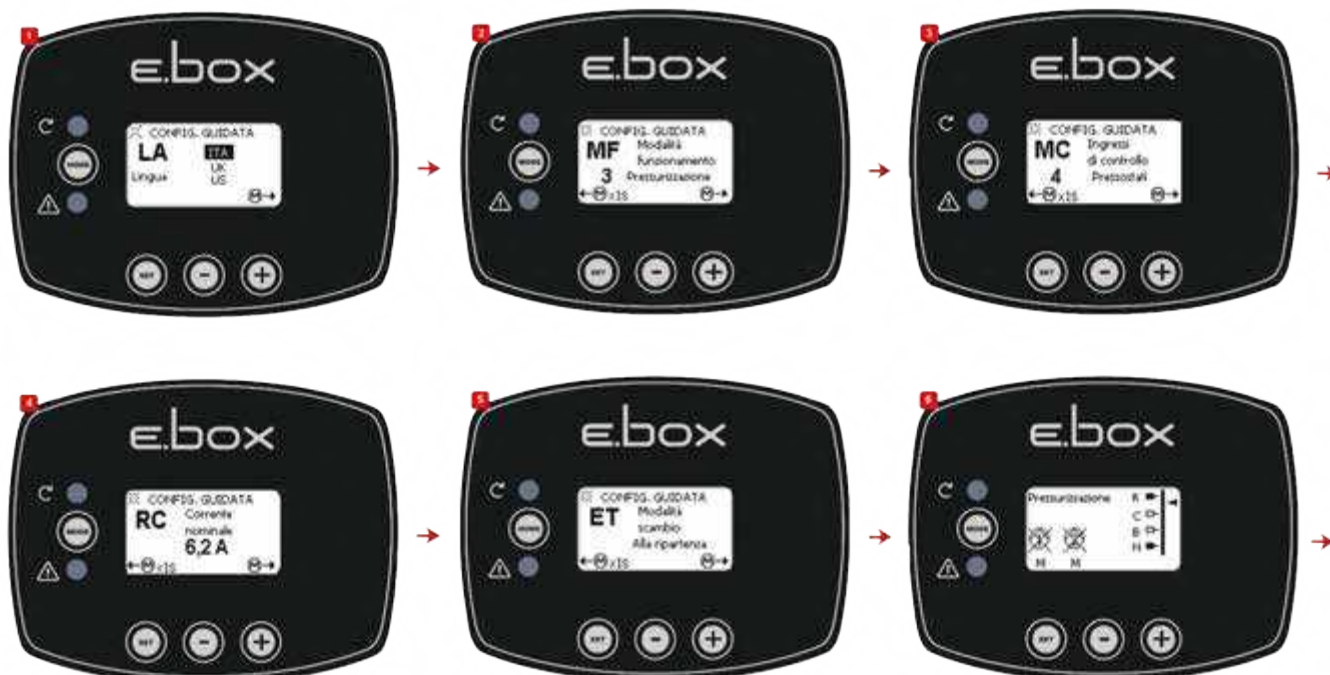
Схема 13: Конфігурація з реле тиску
