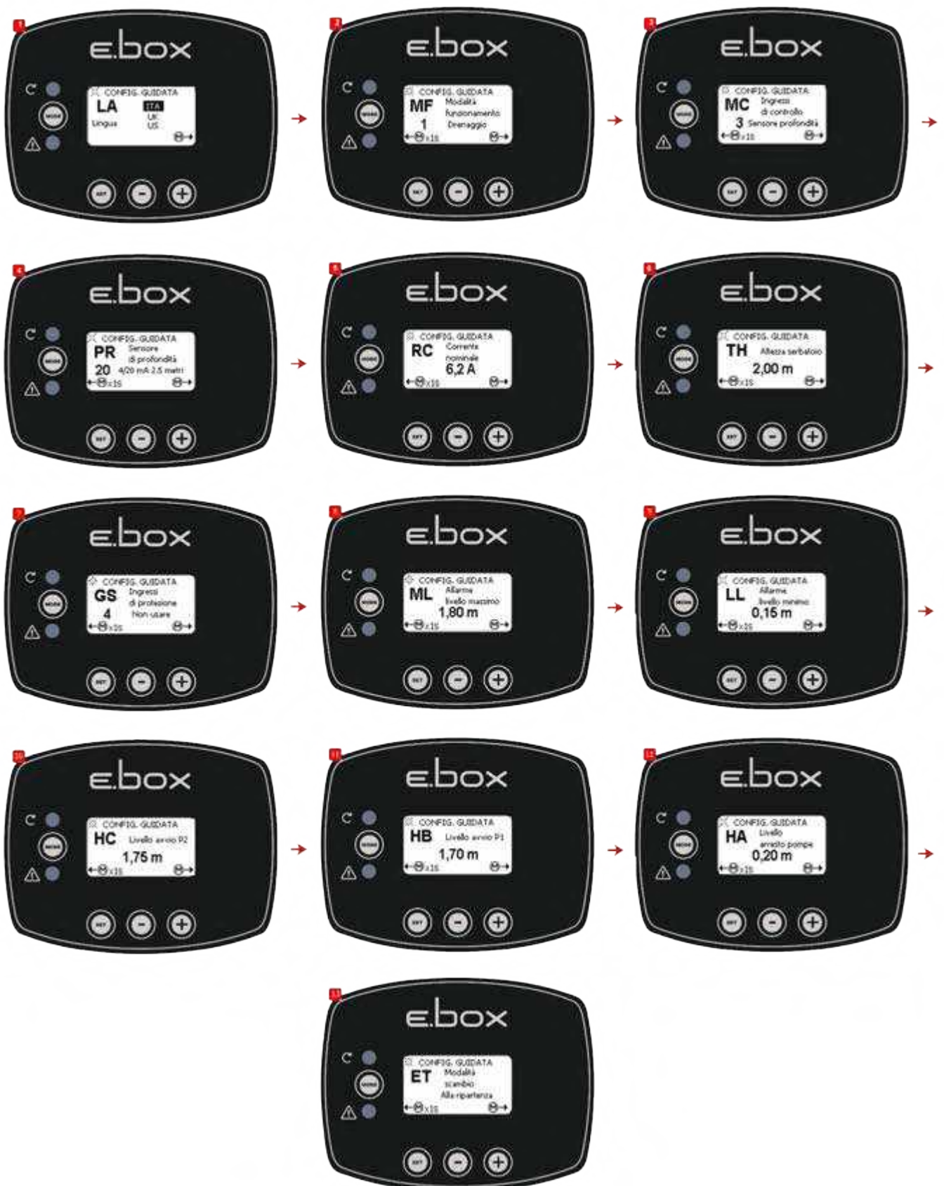
Схема 38: Конфигурация только с датчиком глубины
