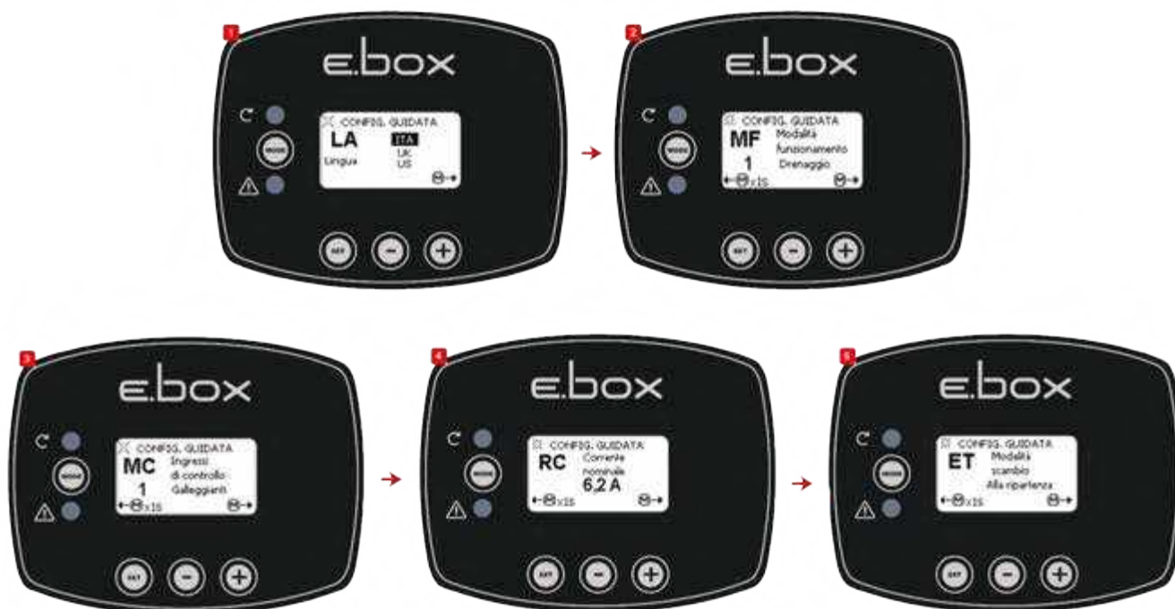
Схема 36: Конфігурація дренажних поплавців або датчиків рівня
