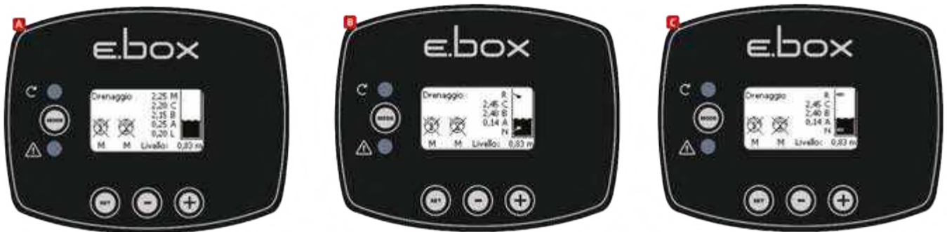
Схема 39: Стан системи при конфігураціях: А тільки з датчиком глибини, В: датчик глибини та поплавці, С датчик глибини та зонди рівня.
