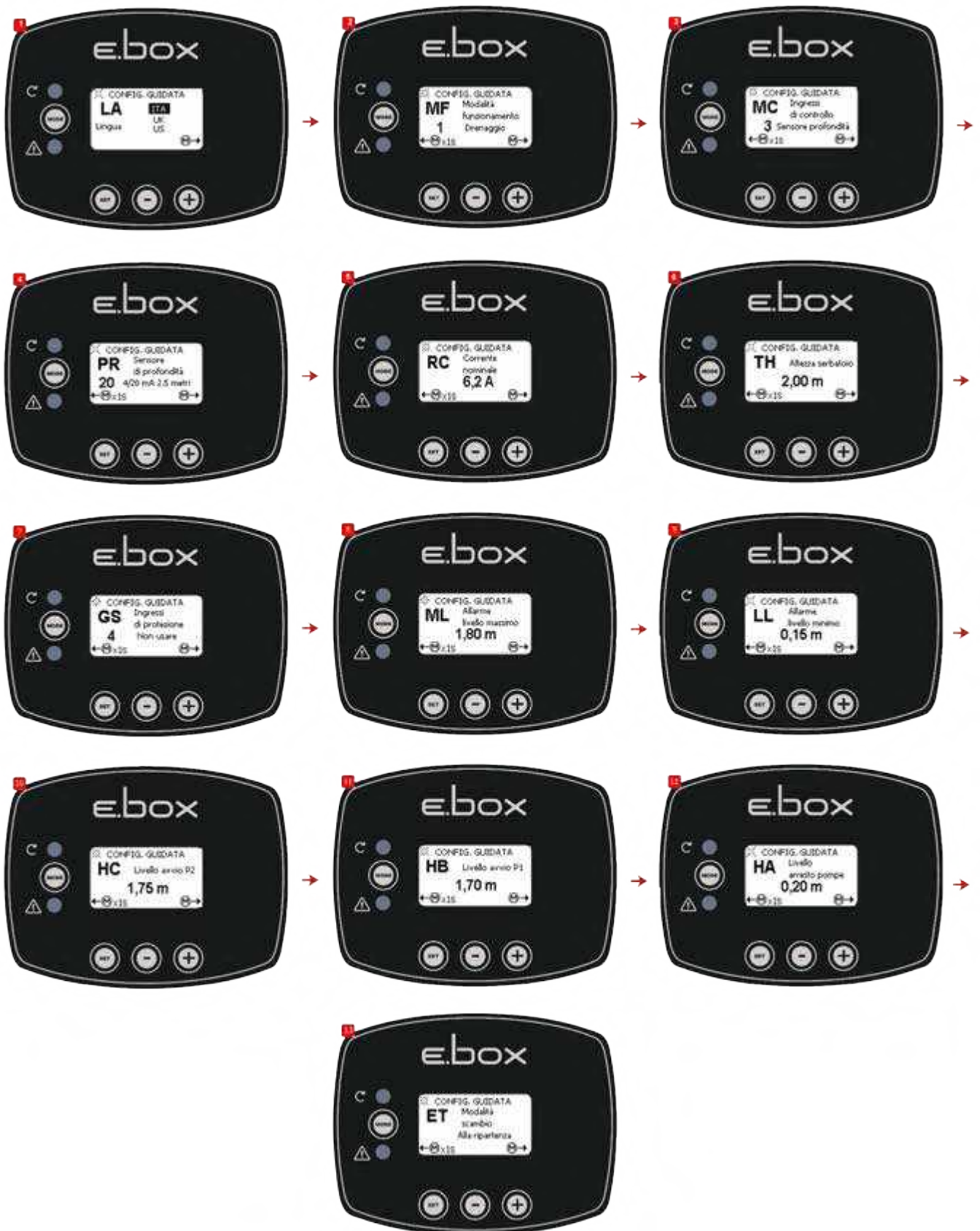
Схема 38: Конфігурація тільки з датчиком глибини
