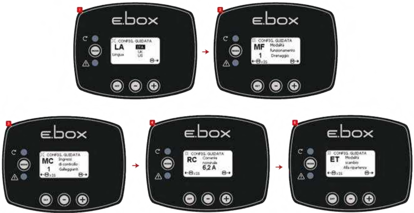
Схема 36: Конфигурация Дренажа поплавков или зондов уровня
