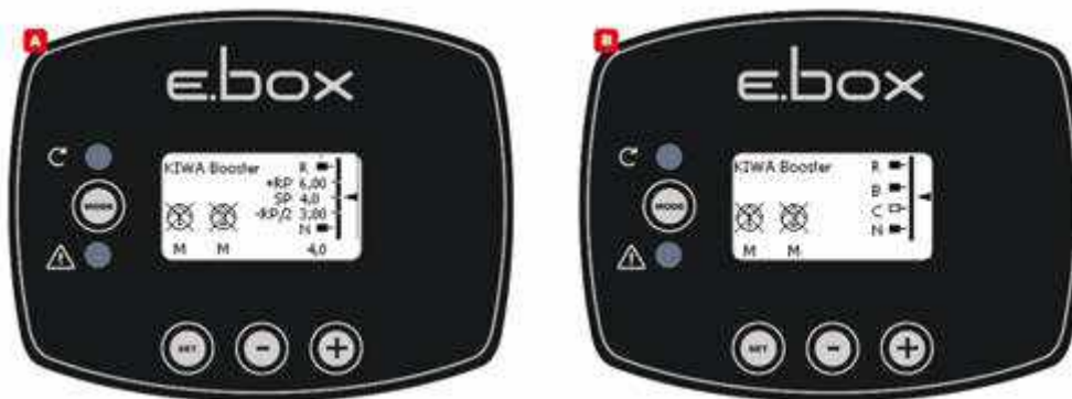
Схема 50: Стан системи в режимі KIWA
