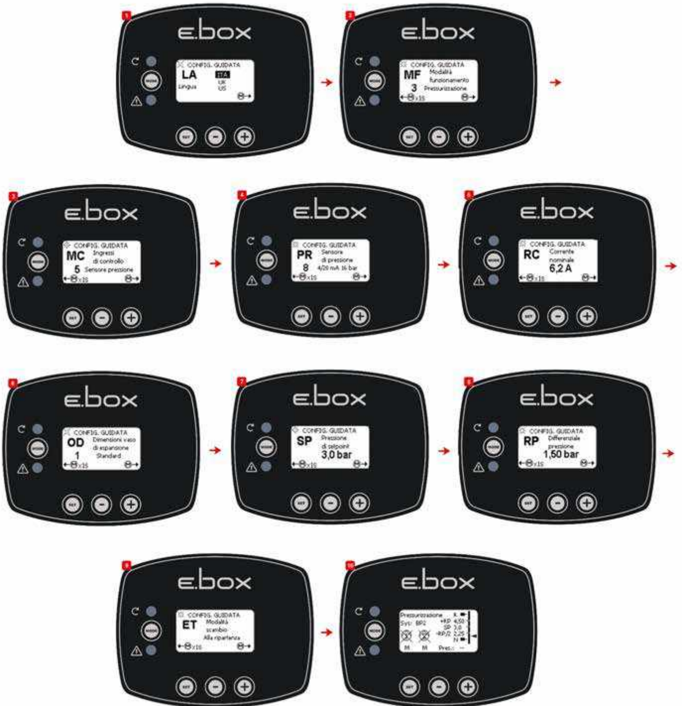
Схема 12: Конфігурація з датчиком тиску
