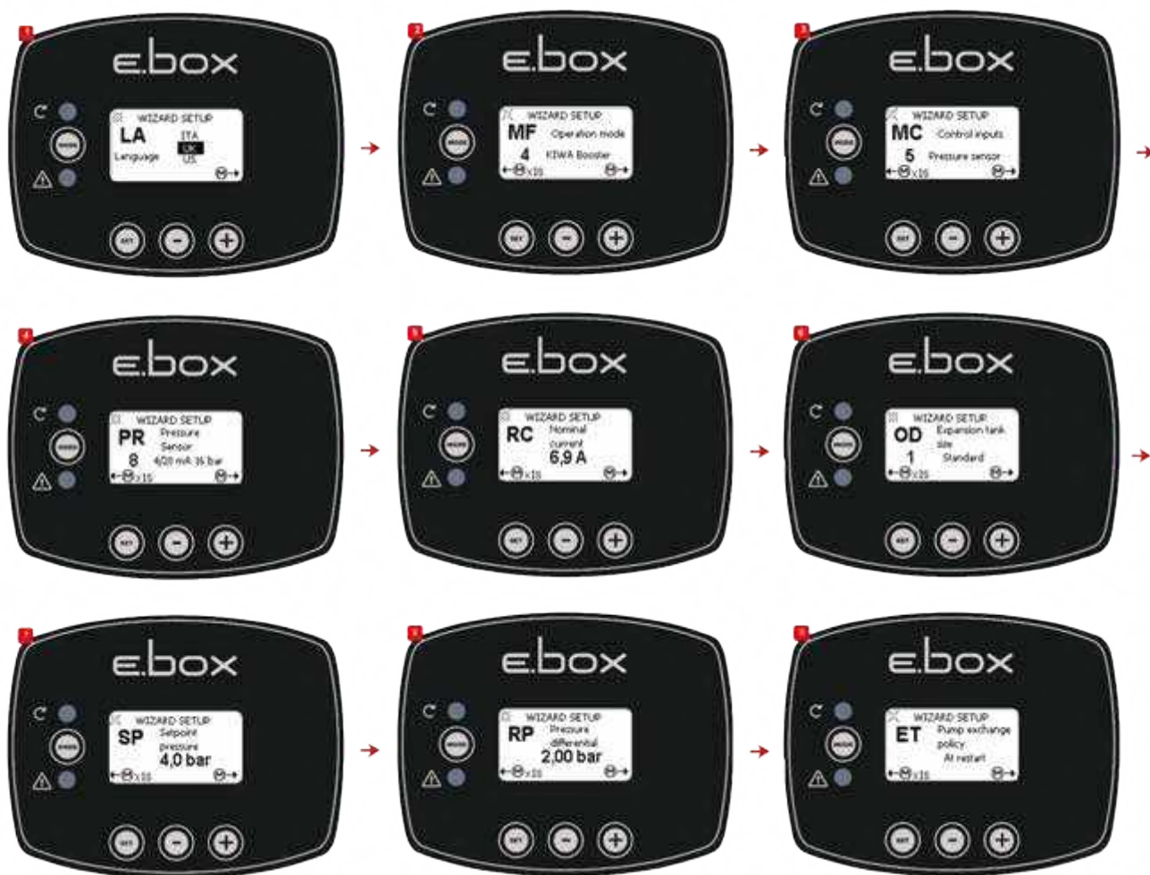
Схема 48: Подпор KIWA с датчиком давления
