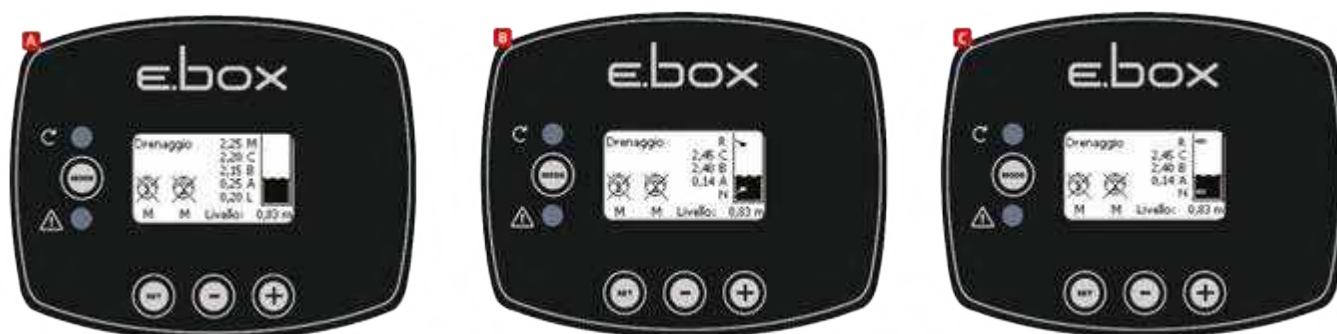
Схема 39: Состояние системы при конфигурациях: А только с датчиком глубины, В: датчик глубины и поплавки, С датчик глубины и зонды уровня.
