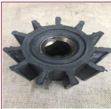
Насос RF представляет собой реверсивный насос с гибким рабочим колесом. Эффект самовсасывания достигается благодаря конструкции насоса, максимальная глубина самовсасывания - 5 метров. Сфера применения насоса RF очень широка, насос способен эффективно перекачивать продукты различной степени вязкости, продукты с включениями, а также газосодержащие продукты. Данный насос используется в сфере виноделия для перекачивания вина или муста.
