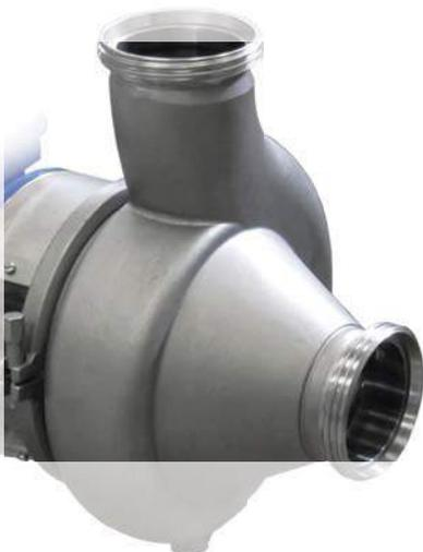
Насос RV - центробежный насос высокой эффективности. Лучший выбор для перекачивания твёрдых веществ в суспензии и продуктов средней вязкости, с которыми не справляется стандартный центробежный насос. Благодаря геликоидальному дизайну его крыльчатки, возможно перекачивание деликатных пищевых продуктов, не повреждая их (в пропорции от 40% до 60%). Идеален для перекачивания кусочков или цельных фруктов, оливок, шампиньонов, долек апельсинов, стручковых, овощей, рыбы, и т.д.
